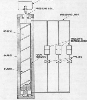
HELICAL SCREW RHEOMETER
